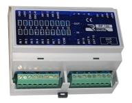
Modulo mini-PLC compatto per il controllo di piccole macchine automatiche. Dispone di buona velocità di elaborazione, 10 ingressi digitali, 10 uscite digitali, 1 controllo di posizione da encoder, 2 uscite analogiche +/-10Vdc, 2 porte seriali RS-485/Can-BUS, orologio datario con batteria al litio, diagnostica di funzionamento mediante file di led frontali, prese di collegamento per pannelli operatore.
