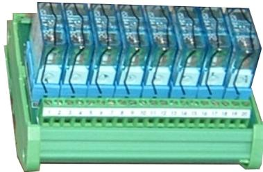
Modulo d'interfaccia passivo a relè che riceve i comandi digitali provenienti da diverse apparecchiature elettroniche quali PLC, PC industriali, moduli di comando, ecc. e pilota carichi induttivi e resistivi di piccola potenza come elettrovalvole, teleruttori, piccoli servomotori, lampade, resistenze, ecc.
