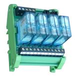
Modulo d'interfaccia passivo a relè che riceve i comandi provenienti da apparecchiature elettroniche quali PLC, PC industriali, moduli di comando, ecc. e pilota carichi induttivi e resistivi di piccola potenza come elettrovalvole, teleruttori, piccoli servomotori, lampade, resistenze, ecc. Questo tipo di modulo dispone di una serie di morsetti a vite che lo rende universale e di un connettore a flat multipolo per il collegamenti rapidi.
