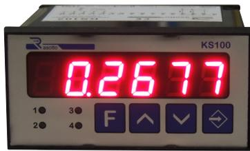
Strumento a microprocessore con ingresso da T.A. e calcolo automatico del coefficiente di correzione impostando il valore di fondo scala.
