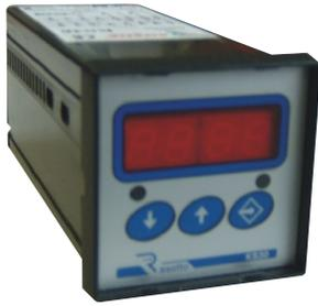
Contatore ad incremento - decremento adatto per conteggi lenti da contatti di tipo meccanico oppure da trasduttori veloci come proximity, fotocomandi, encoder monodirezionali.
